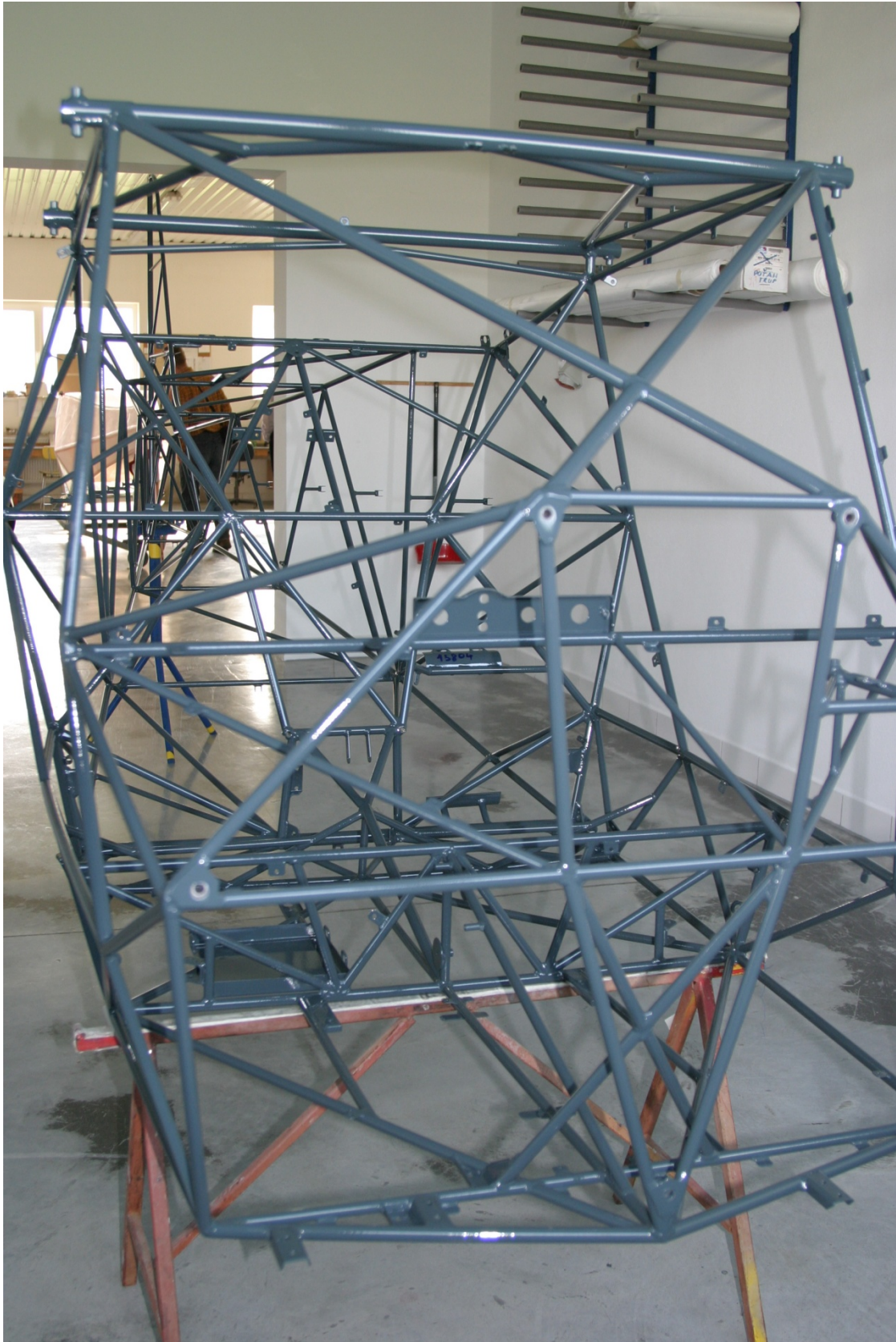
Ristikkorakenteinen lentokonerunko edestäpäin katsottuna. © Nils Rostedt 2008.
