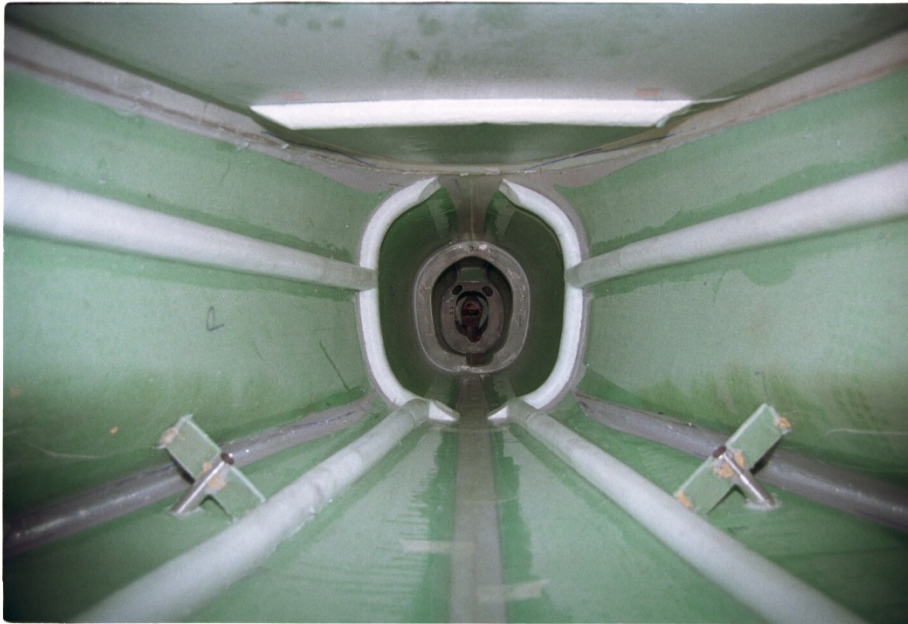
Puolikuorirakenteisen lentokonerungon sisätilaa. Seinämät on vahvistettu liimatuilla pituusjäykisteillä ja muotokaareilla (taaempänä). © Nils Rostedt 2008.
