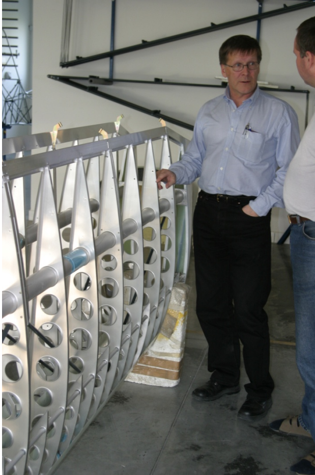
Metallirakenteinen siipi (puolikuorirakenne, ultrakevyt Eurofox) © Nils Rostedt
